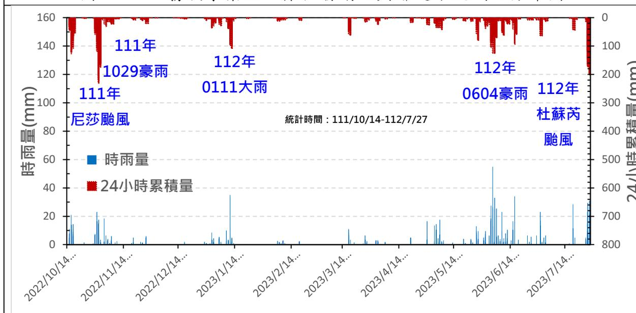
圖 2-2、清水斷崖雨量站近期降雨組體圖(111/10/14-112/7/31)
