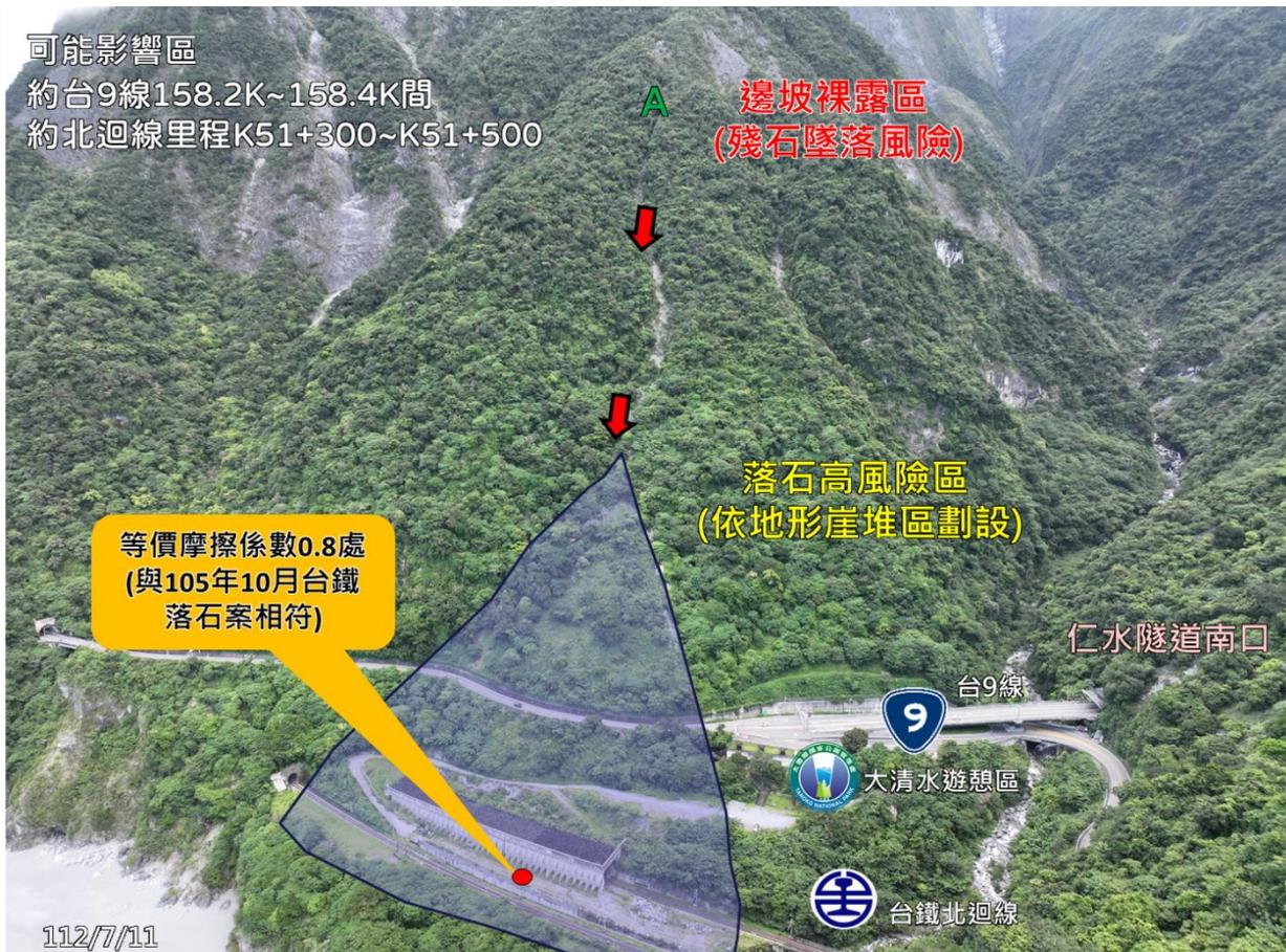
圖 7-11、邊坡裸露殘石可能影響範圍空拍套繪成果
