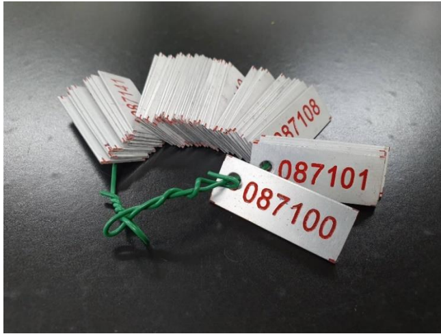
圖2.4、標示樹木之鋁牌。鋁牌上面有深刻上漆之流水號，利於辨識。
